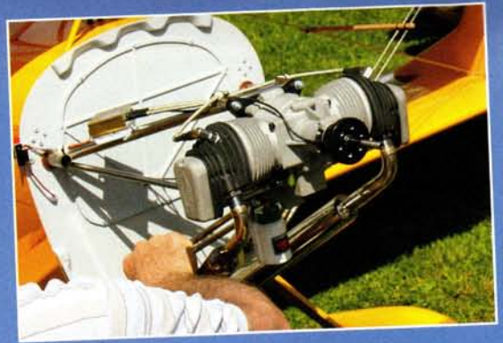
Erstmalig präsentierte Gerhard Reinsch seine über 3 m große »Pitts S1-S« im Deutschland-Design. Bei einem Blick unter die Motorhaube erkennt man sofort den brandneuen Valach-170-cm 3 -Viertaktmotor, aufgehängt an einem Motorträger aus Edelstahlrohren
