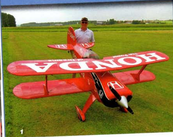
1 Günther Holzwarth präsentierte auch heuer stolz seine »Pitts S1-S« mit 3,04 m Spannweite. Das Modell wird von einem 3W-Zweizylinder mit 210 cm 3 angetrieben 2 Eine »Pitts Python«, das jüngste Mitglied aller »Pitts«-Derivate. Dieser Modellnachbau
